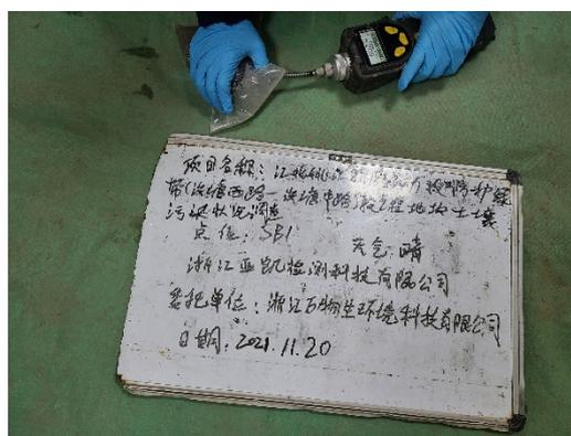
土壤 PID 有机气体测试
