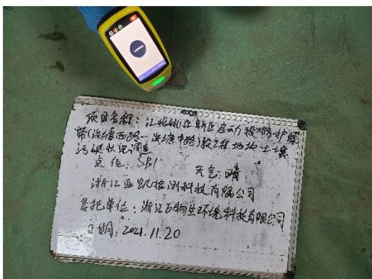
土壤中金属 XRF 测定
