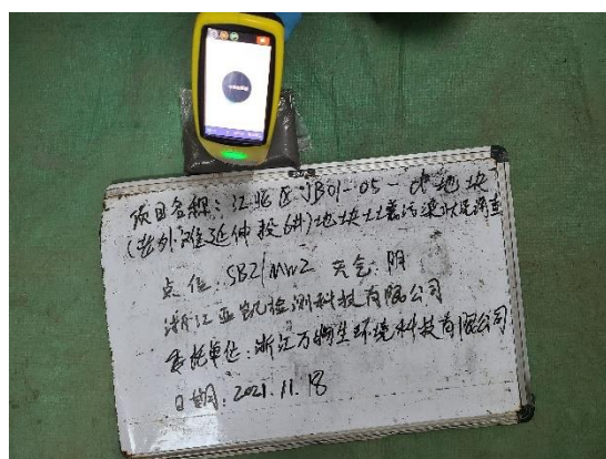
土壤中金属 XRF 测定
